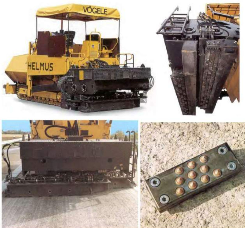
Figur 37. Helmus Grip 2 som användes vid slipning av Eugeniattunneln och Tyresövägen. (Foto från Jacobsen och Hornwall, 2001)
