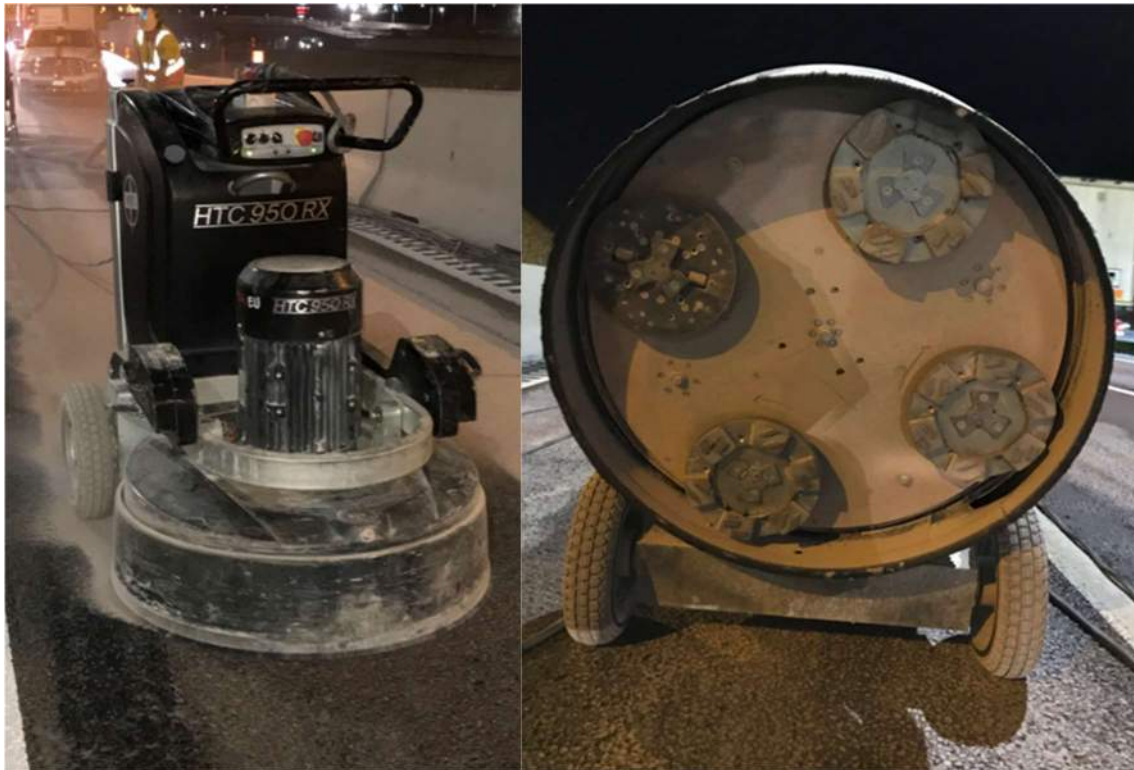
Figur 27. Den maskin som slutligen valdes för att slipa utsatta partier blev HTC 950 RX med fyra roterande slipskivor. Foto: Skanska.
