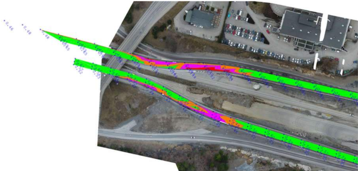
Figur 24. Detaljerad illustration av uppmätta friktionsvärden vid trafikplats Lindvreten Södra (se Figur 2) där låga värden markeras som röda och orangea. Illustration över området skapad av Skanska.
