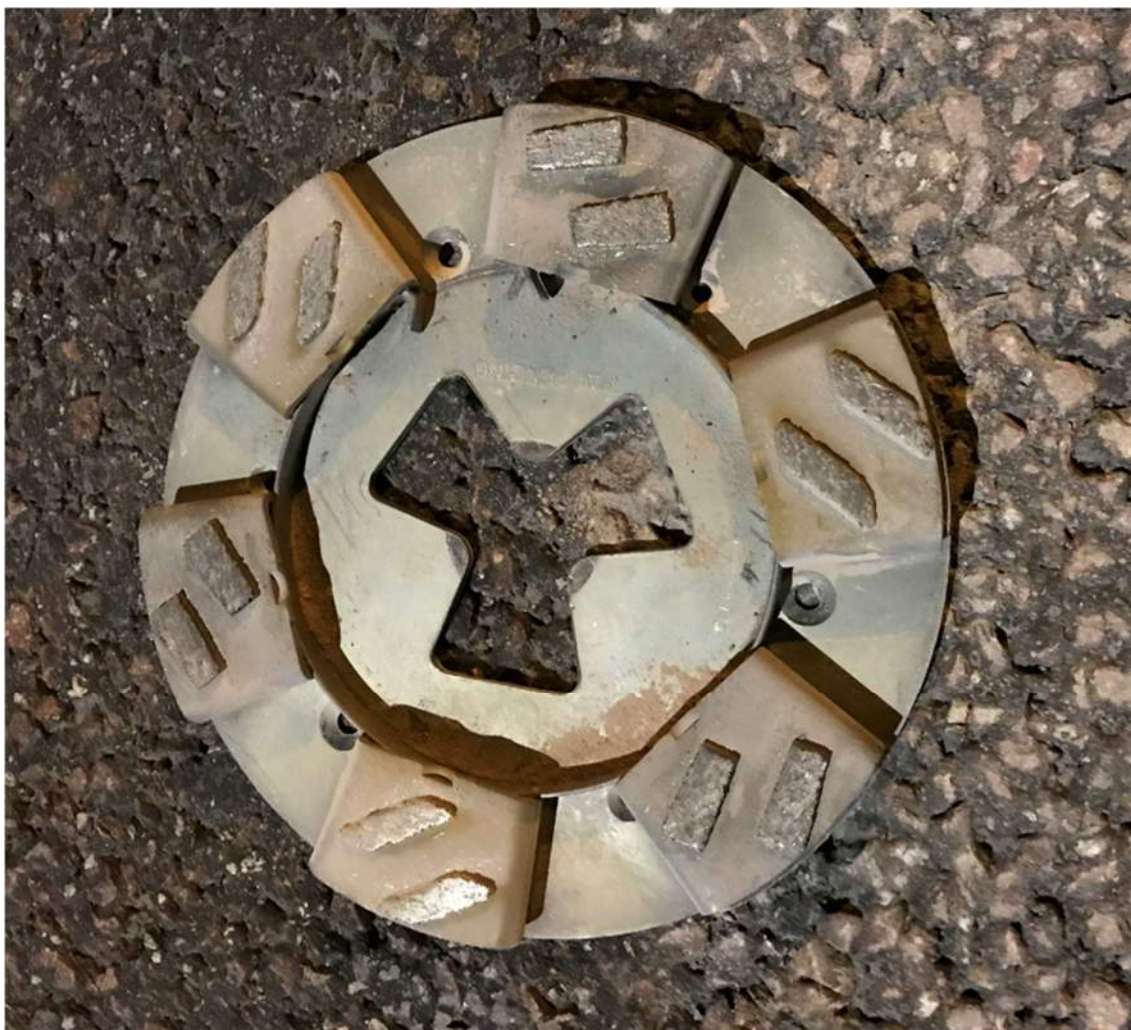
Figur 34. En av slipmaskinens fyra diamantslipskivor efter en natts arbete. Foto: Skanska.
